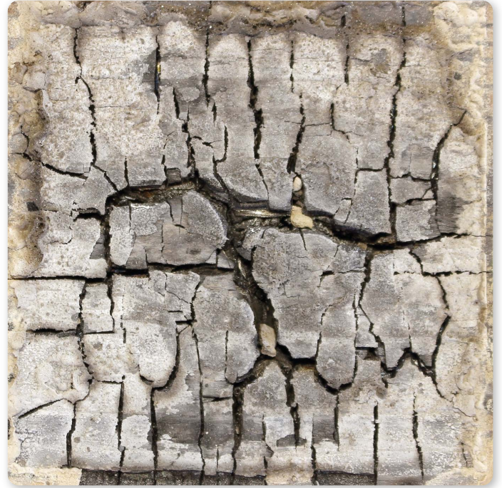
▲ 耐燃焼性試験後の木材
